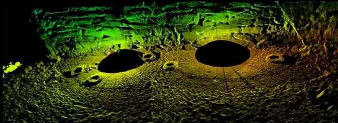
Il rilievo dei dati viene effettuato in posizioni diverse rispetto ai target, allo scopo di acquisire nubi di punti da diverse prospettive e combinarle/ricomporle successivamente per formare l'oggetto scansionato nella sua totalità.
